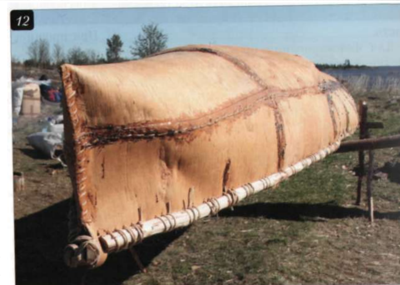
Рис. 11. Лодка после закрепления бортов на «раме» и прокладки стрингеров.
