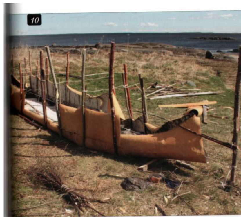
Рис. 10. В процессе «пришивания бортов берестяной лодки».
